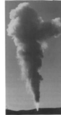
Camada cisalhante turbulenta entre 2 correntes de gases diferentes. Alto Reynolds.  $Re \approx 200.000$
