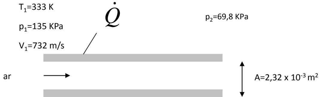
$$C_1 = \sqrt{1,4 \cdot 287 \cdot 333} = 365,8 \text{ m/s} \quad \rho_1 = (p_1 / (R T_1)) = 1,41 \text{ kg/m}^3 \quad \dot{m} = \rho_1 V_1 A = 2,4 \text{ kg/s}$$
