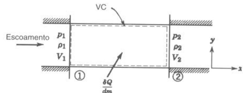
Temos 6 equações, porém temos 7 incógnitas ( $\rho_2, V_2, p_2, h_2, T_2, s_2, dQ/dm$ ).
